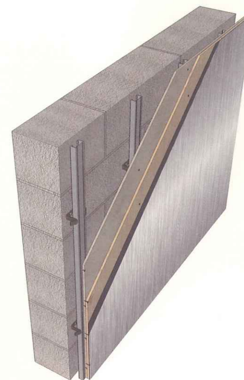
金属薄板粘贴墙面三维示意图 轻质砖墙体
