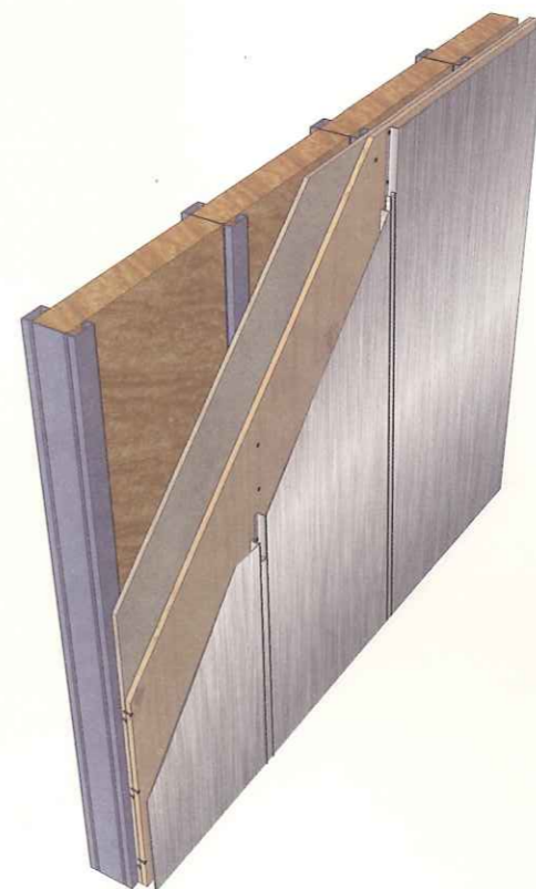
金属挂板墙面三维示意图 轻钢龙骨墙体
