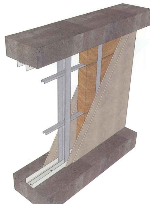
轻钢龙骨墙三维示意图二
