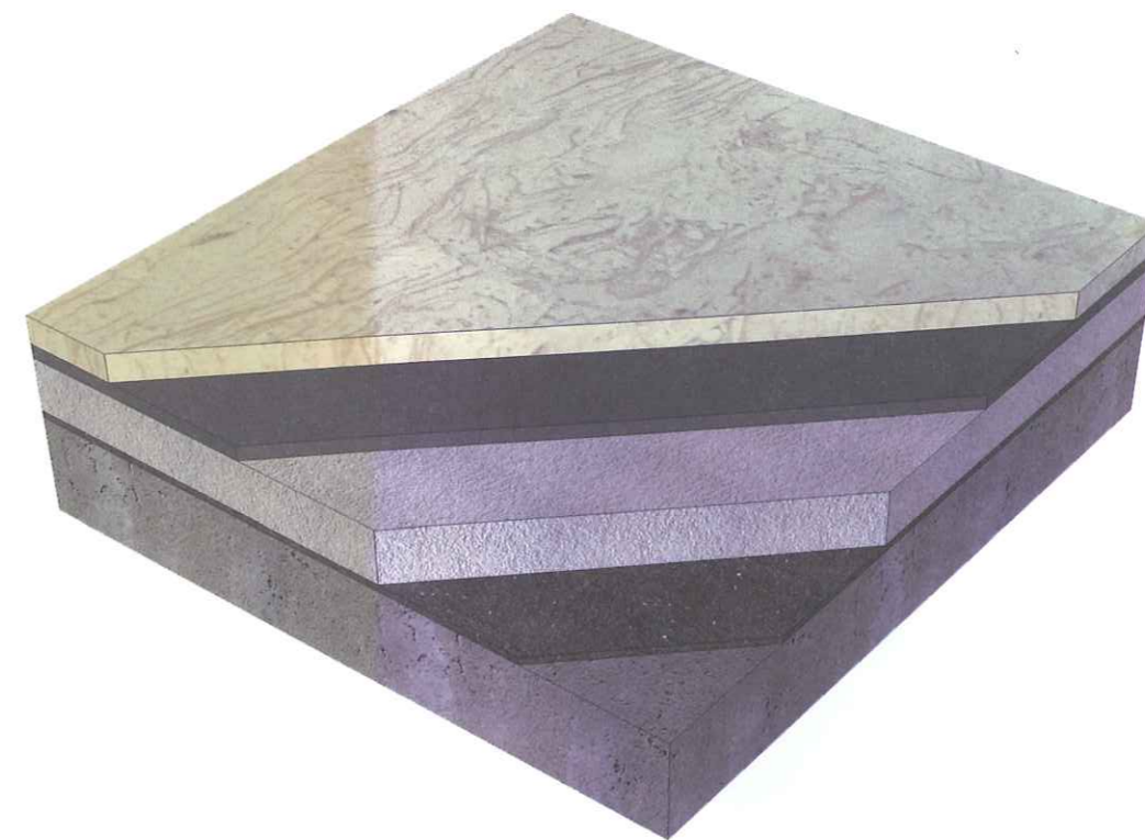
石材/瓷砖地坪三维示意图 干铺法
