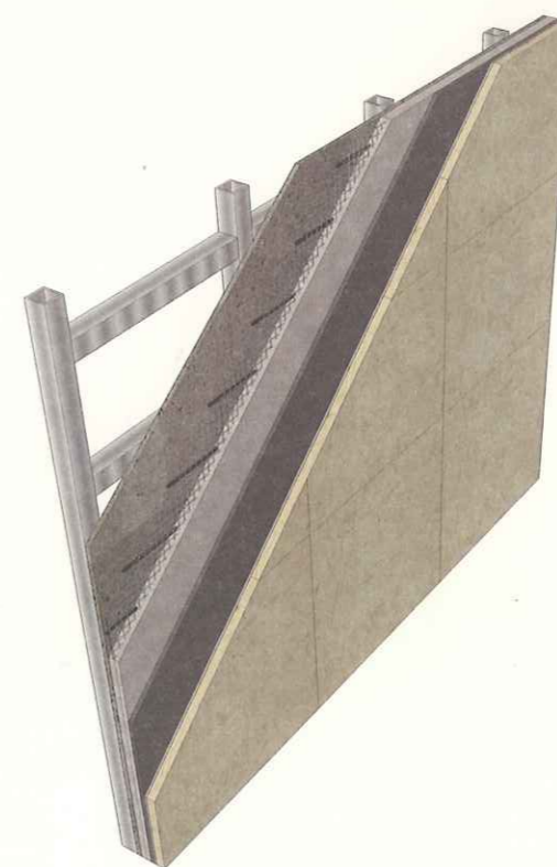
瓷砖/石材湿贴墙面三维示意图 钢架墙体
