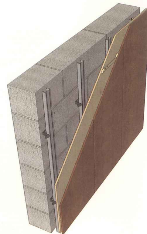
木饰面挂板墙面三维示意图
