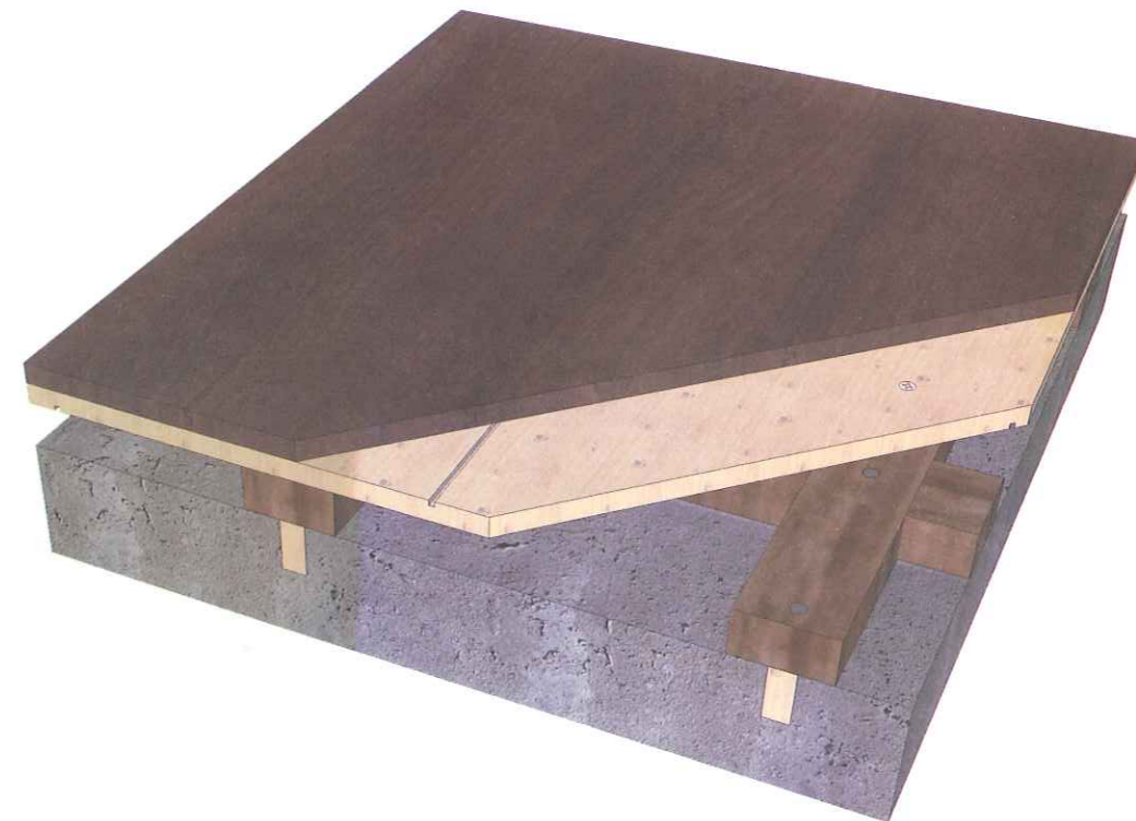
木地板地坪三维示意图 木龙骨基层
