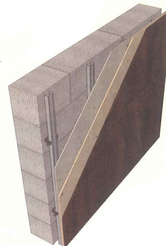
木质吸声板墙面三维示意图 轻质砖墙体
