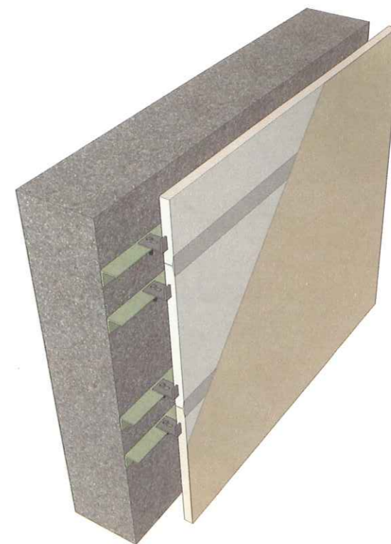
GRG/GRC挂板墙面三维示意图
