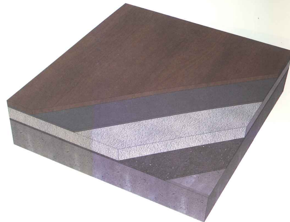
木地板地坪三维示意图 混凝土基层
