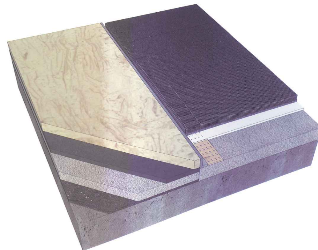
石材-满铺地毯交接地坪三维示意图
