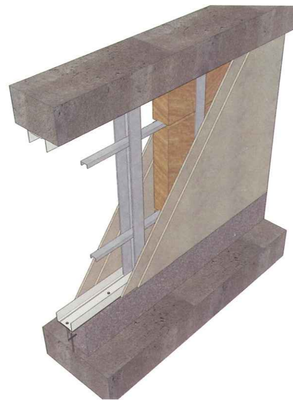
轻钢龙骨墙三维示意图一
