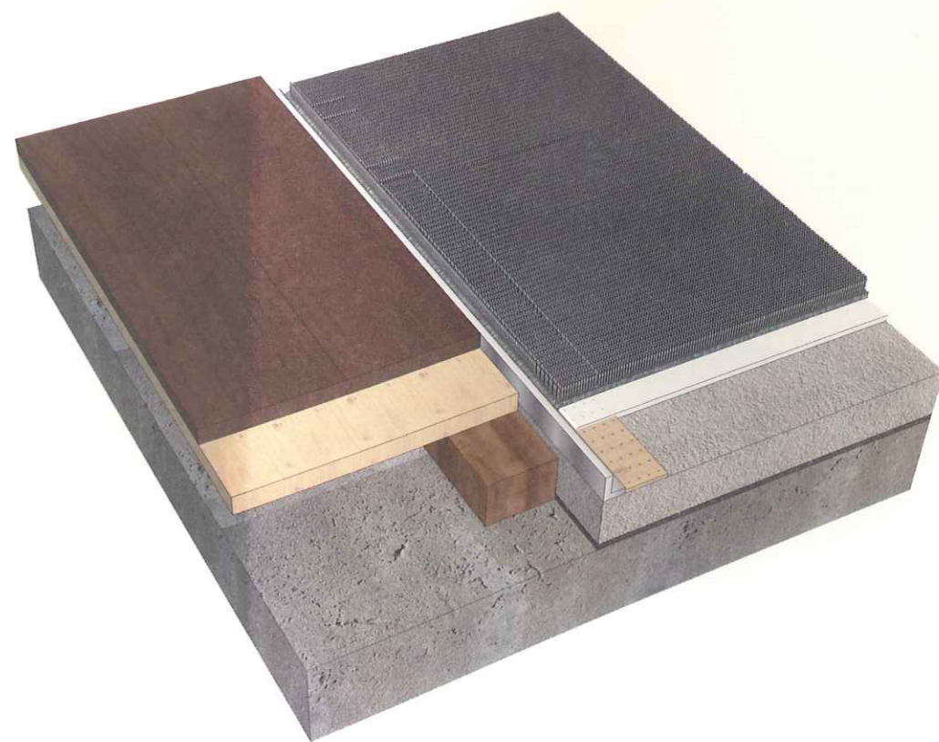
木地板-满铺地毯交接地坪三维示意图
