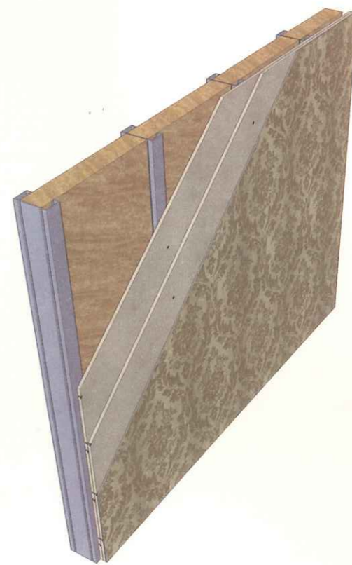
壁纸饰面墙面三维示意图 轻钢龙骨墙体
